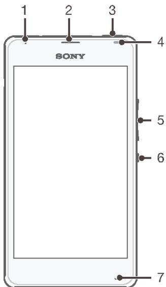
1 Indikátor nabíjania/indikátor upozornenia
