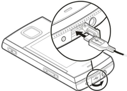
Otvorte kryt konektora USB a zapojte do prístroja kábel USB.
