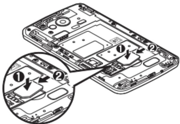
**3** Batériu vložte na miesto, zarovnajte pritom zlaté kontakty telefónu a batérie a batériu (1) jemne zatlačte, aby zapadla do príslušnej polohy (2).
