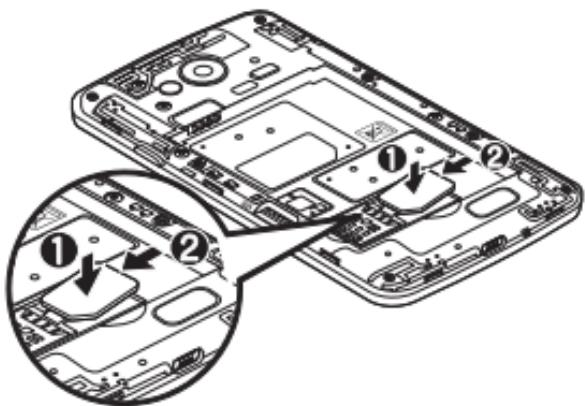
**3** Vložte baterii do příhrádky pro baterii, aby na sebe přiléhaly zlaté kontakty na baterii a na telefonu (1). Potom na baterii mírně zatlačte, aby zapadla na své místo (2).
